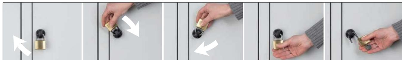
Hier ist kein gewaltsames Aufbrechen durch Überdrehen des Vorhängeschlosses mehr möglich. Im geschlossenen Zustand lässt sich der Verschluss um 360° durchdrehen. Erst nach Entfernung des Vorhängeschlosses rastet der Schließzylinder ein, so dass durch Drehung des Verschlusskopfes die Tür geöffnet werden kann.
