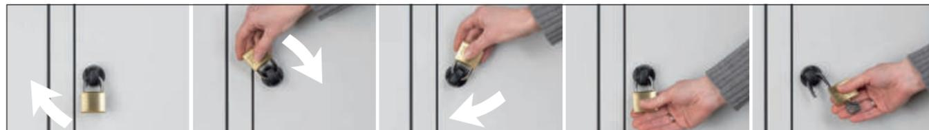
Hier ist kein gewaltsames Aufbrechen durch Überdrehen des Vorhängeschlosses mehr möglich. Im geschlossenen Zustand lässt sich der Verschluss um 360° durchdrehen. Erst nach Entfernung des Vorhängeschlosses rastet der Schließzylinder ein, so dass durch Drehung des Verschlusskopfes die Tür geöffnet werden kann.
